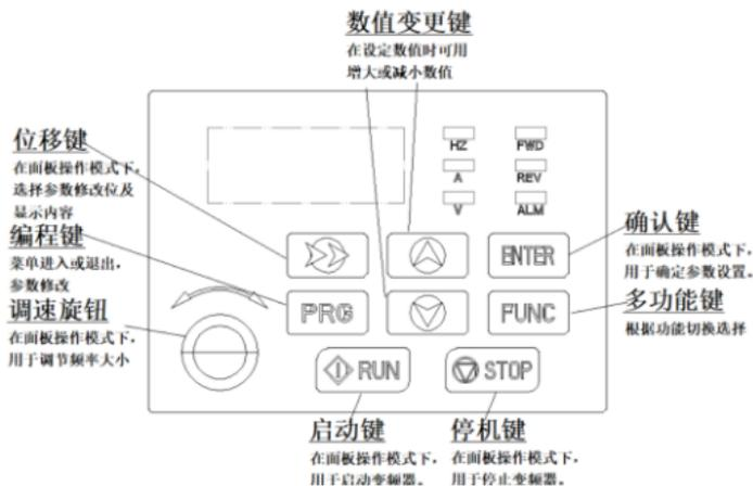
注意: 变频器上电后运行面板显示 50.0(输出频率)
