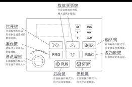
注意: 变频器上电后运行面板显示 50.0(输出频率)
